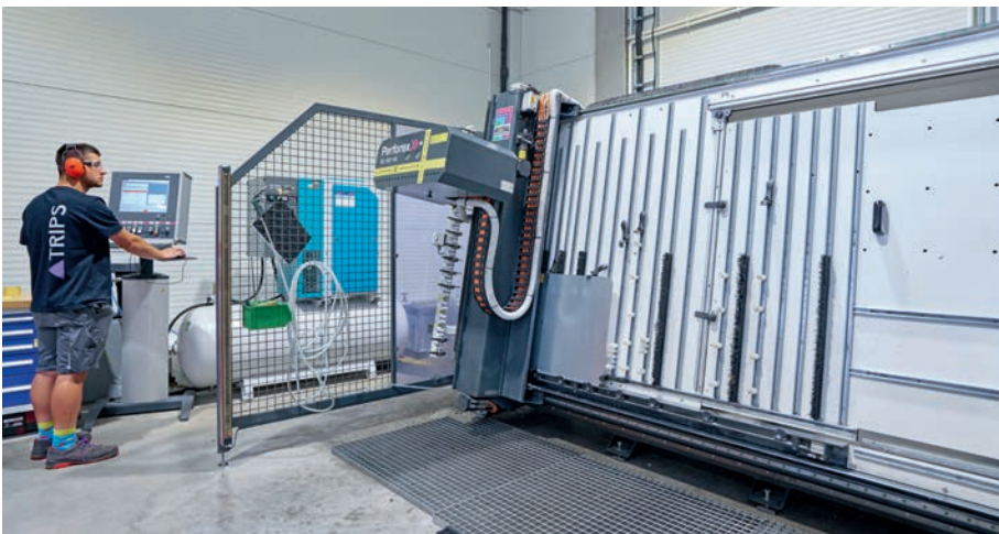
Mit dem Bearbeitungszentrum Perforex von Rittal lassen sich im neuen Werk von TRIPS Automatyka Polska Schaltschränke und Flachteile auf Knopfdruck automatisiert bearbeiten.
